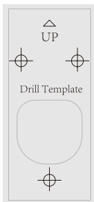
Ovipuhelinpaneelin porauskaavio (x1)
